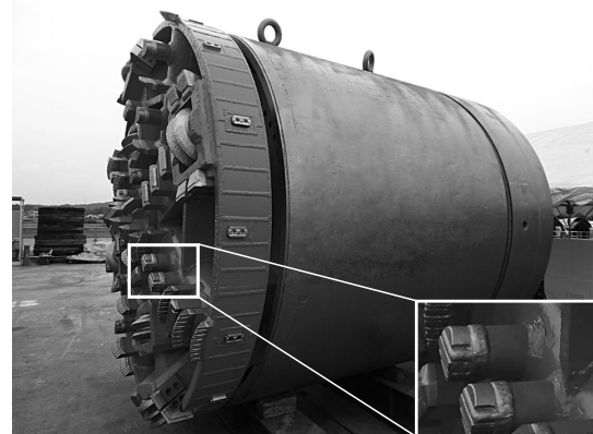
写真-2 銅棒ビットを装備した掘進機
