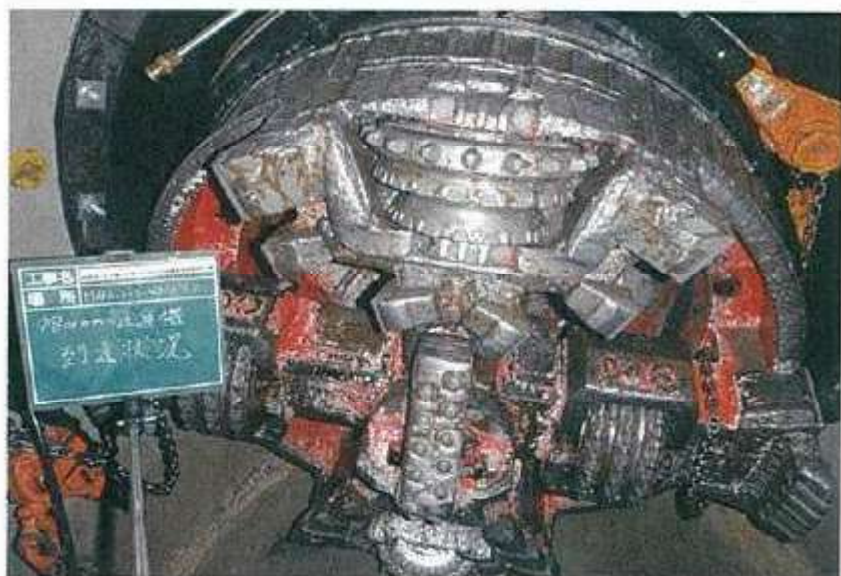
写真-4 到達時のカッタヘッド（最外周のチップが捻転している）
