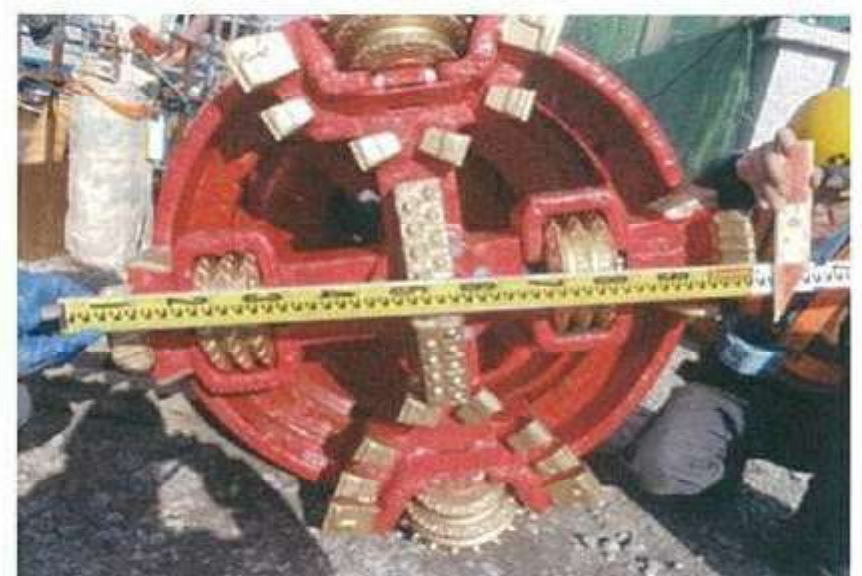
写真-3 チップインタイプのディスクカッタ（最外周はチップを埋め込んだ）
