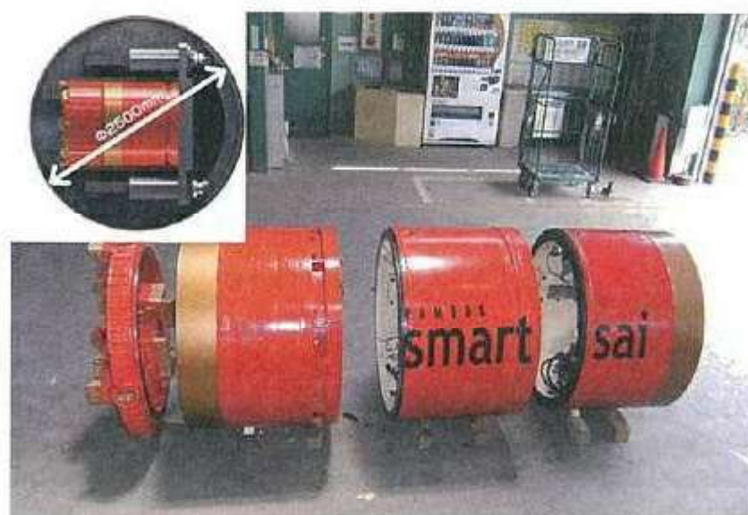
写真-1 小型立坑発進型掘進機
